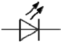
Schaltzeichen einer Leuchtdiode
